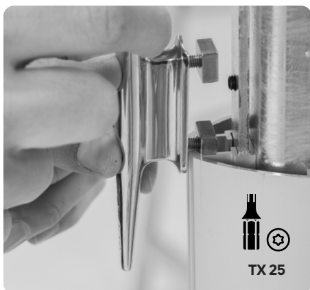
1a Zuerst unterste Komponente reingeben. (z.B. Klampe oder Snap-Grundplatte mit Fallstopklemme)
